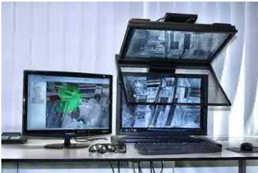
Abb. A-4-3: Arbeitsplatz zur digitalen stereoskopischen Luftbildinterpretation
